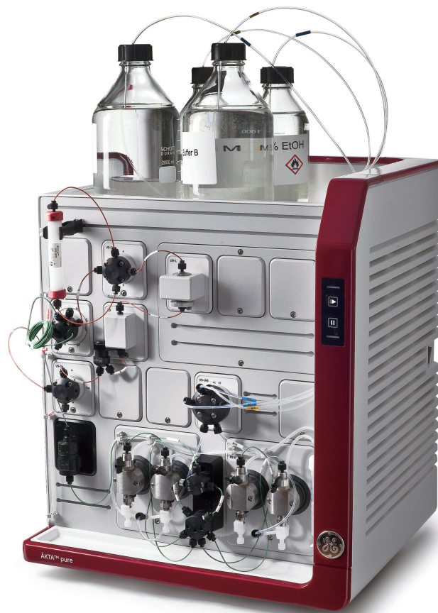
图 1. ÄKTA pure 是一种用于蛋白质、肽和核酸在实验室规模的可靠纯化的灵活色谱系统。
