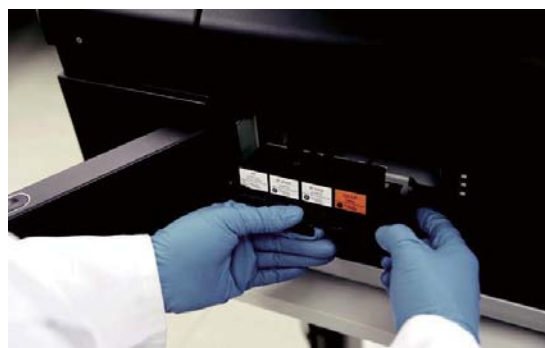
图9. 用户可以轻松更换滤光片。
