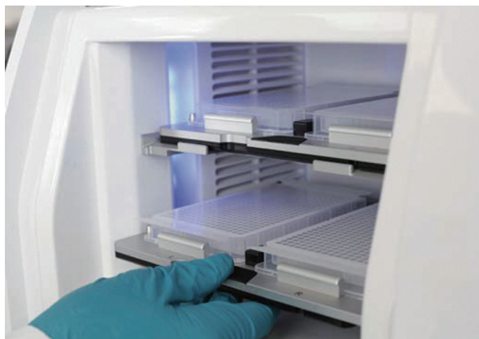
图 7. Biacore 8K 样品舱可同时放置 4 块 96 或 384 微孔板，并且可严格控温，以确保样品的稳定，并得到理想的检测结果。
