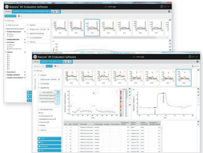
图 10. Biacore 8K 分析软件界面简洁，便于数据浏览，灵活的参数设定使用户能够自定义数据分析，在结果散点图中，成千上万的样品能同时分析和呈现。
