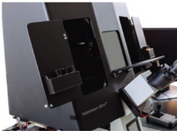
遮光型环境舱，可以适应任何显微镜房间，内置存储架可用于存放常用配件
