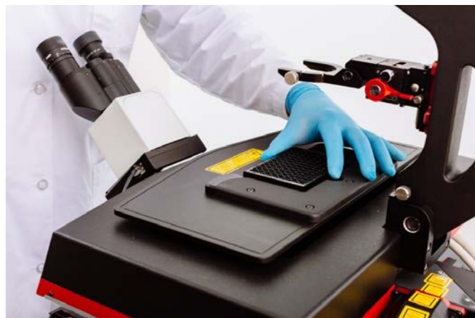
载物台可承载的样品类型：35mm培养皿/玻片/2,4,8腔室盖玻片与载玻片/6,24,96,384多孔板
