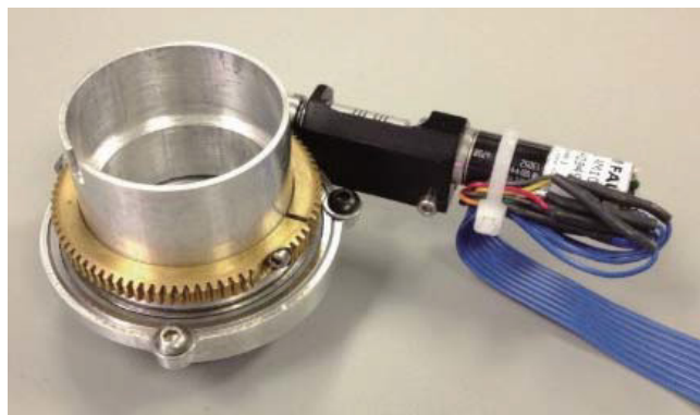
图 4. 定制的电机马达可通过软件设置自动校正球差环。
